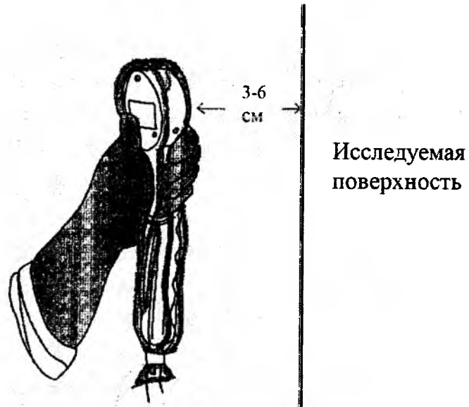
Рисунок 34.1 – Рекомендуемый способ обращения с поверхностным датчиком при определении загрязнения
